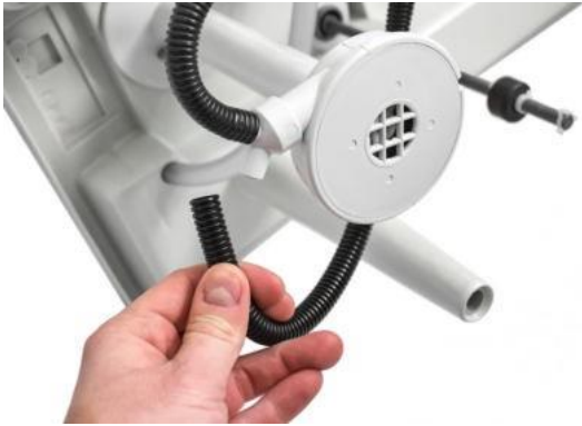
Kuva 7.4.1.5: Pumpun letkujen irrottaminen.
