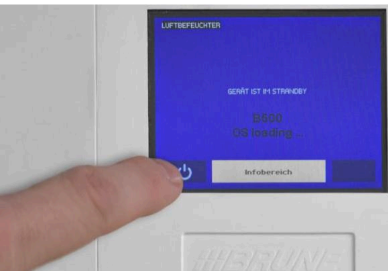
Kuva 4.3.6: Ilmankostuttimen kytkeminen päälle.
