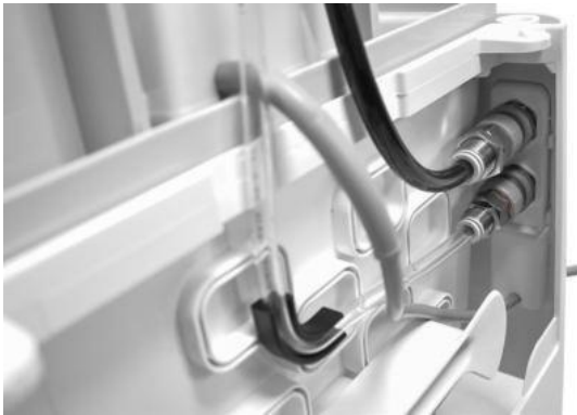
Kuva 6.3.4.12: Virtakaapelin, AWZ:n ja huuhtelulaitteen kytkentä.
