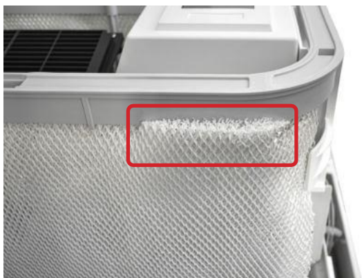
Kuva 6.3.2.5: Suodattimen virheellinen sovitus.
