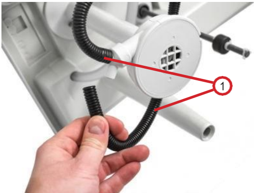
Kuva 6.3.4.4: Pumpun letkujen irrottaminen.
