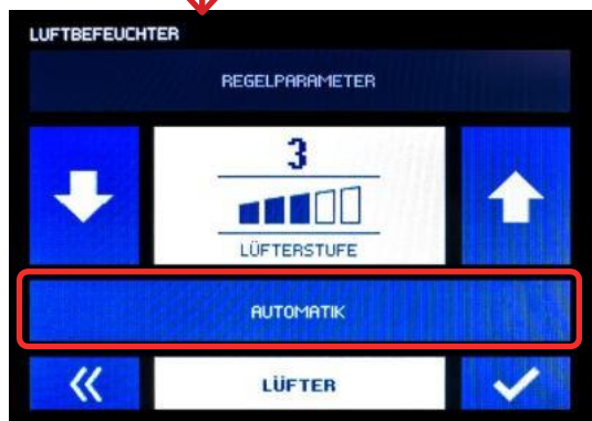
Kuva 5.5.2: Puhaltimen nopeuden asettaminen
