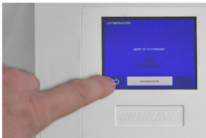
Kuva 5.2.1: Laitteen kytkeminen päälle.
