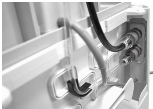
Kuva 6.3.4.4.4: Virtakaapelin, AWZ:n ja huuhtelulaitteen kytkentä.
